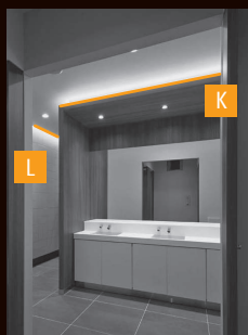
K ルーチ・パワーフレックス 特注品 20mm ピッチ 型番 LFP20-T** - L27-CL-I 電球色 2700K 563 lm/m
