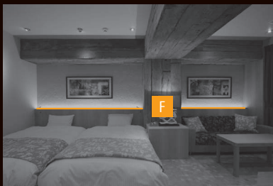
F ルーチ・パワーフレックス 特注品 30mm ピッチ 型番 LFP30-T** -L27-CL-I 電球色 2700K 361 lm/m
