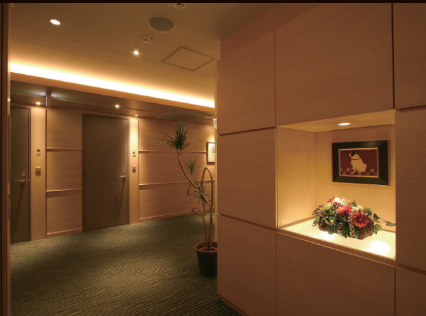
D ルーチ・パワーフレックス 特注品 20mm ピッチ 型番 LFP20-T** - L27-CL-I 電球色 2700K 563 lm/m
