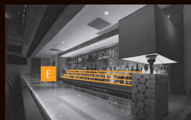
E ルーチ・パワーフレックス 特注品 20mm ピッチ 型番 LFP20-T**・L27-CL-1 電球色 2700K 563 lm/m
