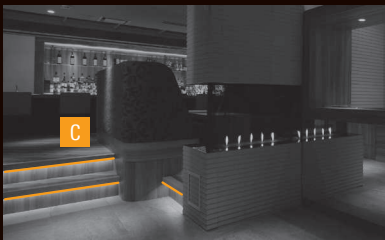
C ルーチ・パワーフレックス 特注品 20mm ピッチ 型番 LFP20-T** - L27-CL-I 電球色 2700K 563 lm/m
